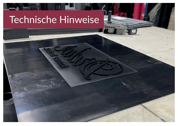
Im Rahmen des Designs und der gewählten Abmessungen sollten eine einfache Entschalbarkeit im Fokus stehen. Damit die Schalungsmatrize einfach und ohne Beschädigung nach dem Aushärten des Betons entfernt werden kann, empfehlen wir Ihnen:
